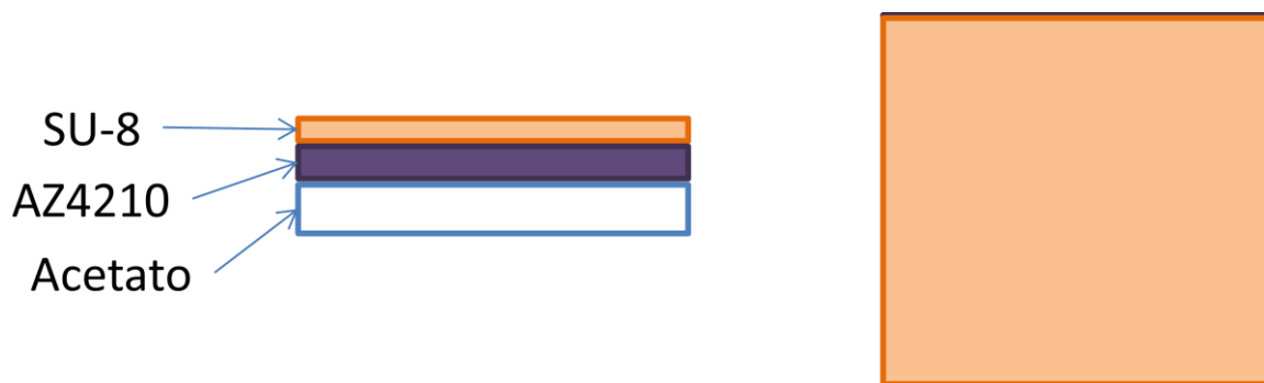
Figura 58 - Ilustração esquemática com vista lateral e superior da metade superior do CMUT.
