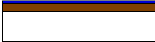
Figura 18 - Perfil da metade de cima do CMUT, membrana e eletrodo superior.
