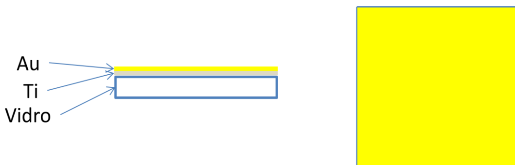
Figura 41 - Ilustração esquemática com vista lateral e superior do substrato com uma camada de titânio e ouro.
