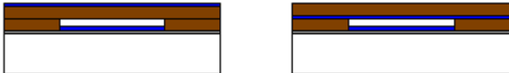
Figura 19 - (a) Perfil do CMUT com o bonding entre duas superfícies de SU-8. (b) Perfil do CMUT com o bonding entre a estrutura inferior de SU-8 e o eletrodo superior.
