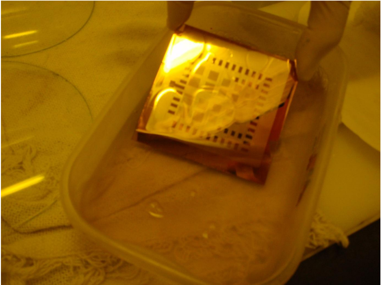
Figura 47 – Exposição do AZ4210 no revelador K400.
